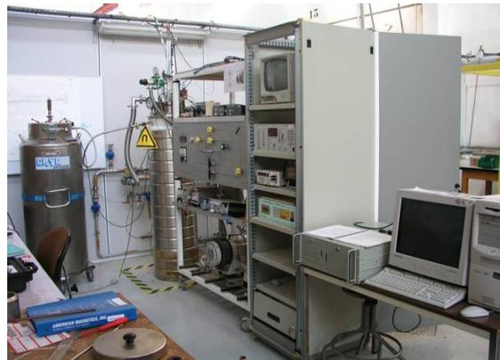
Bobine supra NbTi 10T à 2.17K. d=90mm
